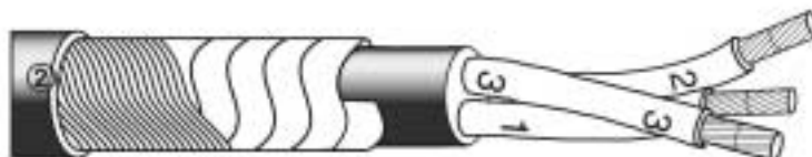
Слой медной ленты с концентрическим слоем медной проволоки.
