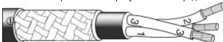
Оцинкованный стальной или луженый медный провод с экраном в виде оплетки.
