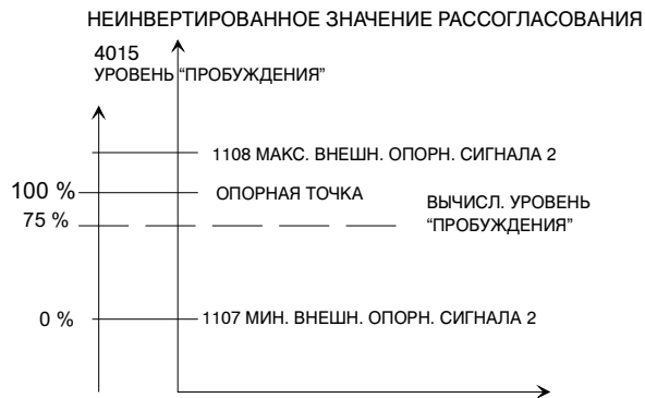
Рисунок 18 Пример изменения уровня "пробуждения", плавающего с опорной точкой, значение параметра 4015 уровень "пробуждени" равняется 75 %, вариант неинвертированного ПИД регулирования.
