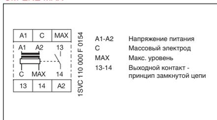
При использовании металлического резервуара от массового электрода С можно отказаться, присоединив кабель непосредственно к металлической поверхности резервуара.
