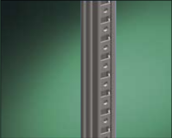
Шаг сетки круглых отверстий для винтов TORX равен 25 мм, что соответствует стандарту DIN 43 660. При использовании вставных гаек M6 возможен шаг сетки 12,5 мм
