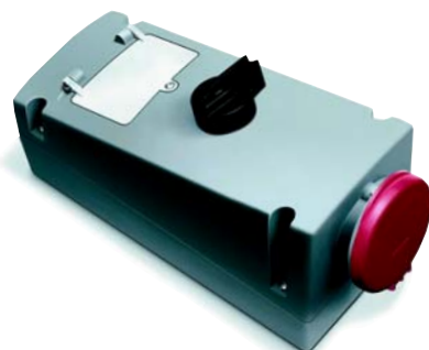
Розетка с выключателем с блокировкой и блоком утечки 30 мА
